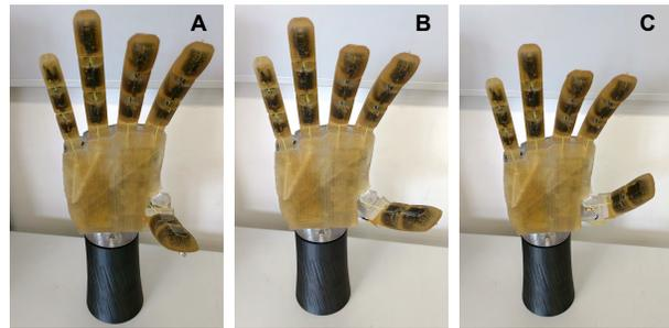
Fig. 4. Three thumb position: A) Cylindrical; B) Spherical; C) Lateral.
